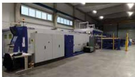
nen Normalstahlbleche bis zu einer Dicke von 25mm geschnitten werden. Die Tischabmessungen sind für 6x2 m Bleche ausgelegt, passend zur Abkantpresse, bei der ebenfalls Bleche bis 6 m Länge verarbeitet werden können. Die Besonderheit an der Anlage ist die automatische Be- und Entstückung.
