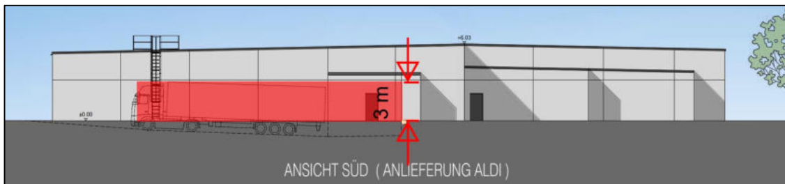
Abbildung 13: Ansicht Süd /11/ mit Eintragung der Lärmschutzwand
